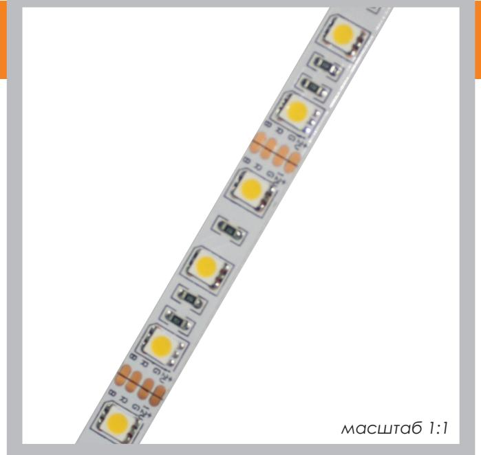
Светодиодная лента повышенной яркости. Открытая (без защиты от влаги), только для применения внутри помещений. Применяемые светодиоды - SMD 5060. Обратная сторона ленты оснащена тонким двусторонним скотчем 3М. Кратность реза ленты - 50 мм. Норма упаковки - 5 м (катушка).
